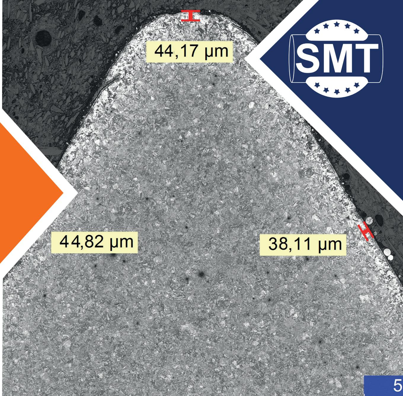
Alcuni organi filettati vengono sottoposti a bonifica per incrementare le caratteristiche meccaniche e per avere strutture in grado di assicurare una buona tenacità.
